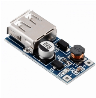
Obr. 3.13: Použitý A7530 DC/DC měnič [4]
