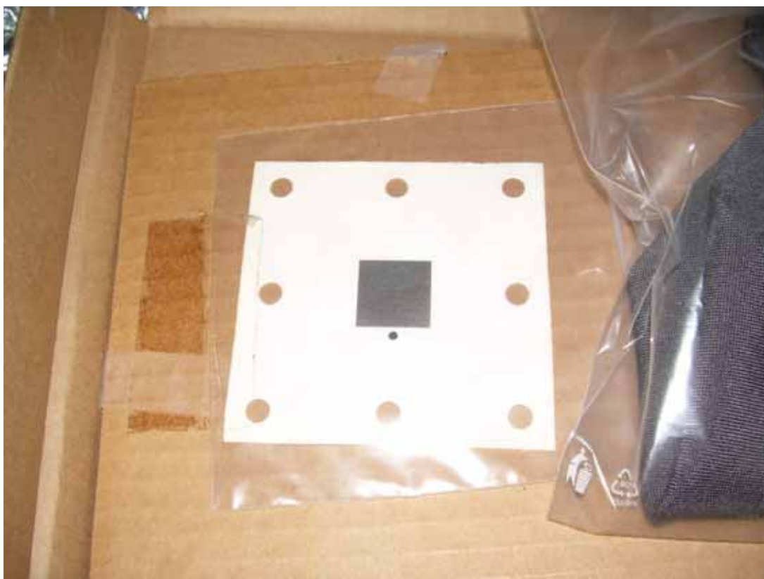
Obr. 10.1: Uhlíková elektroda s katalyzátorem na pozinkované síťce
