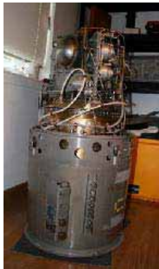
Obr. 2.6: Palivový článek (PEM) pro vesmírný program Apollo [5]
