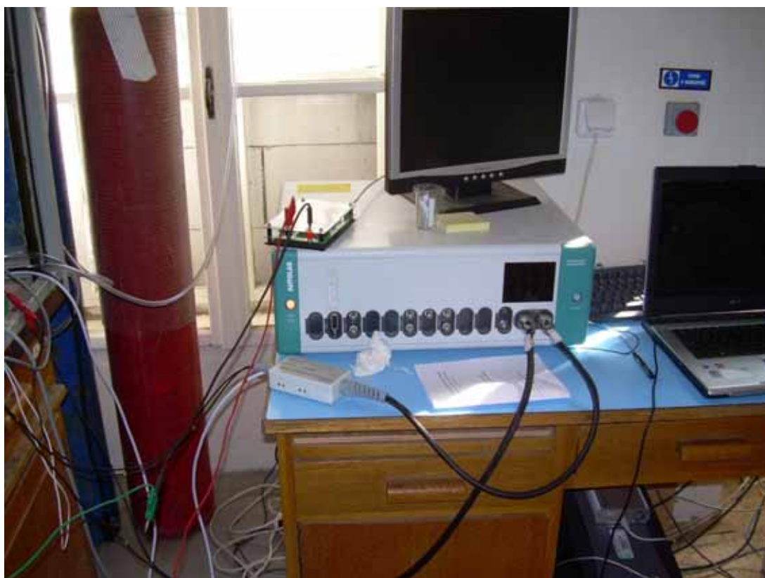
Obr. 8.5: Měřicí přístroj Autolab používaný pro automatická měření a jejich záznam na pevný disk osobního počítače v laboratoři FEKT na Údolní
