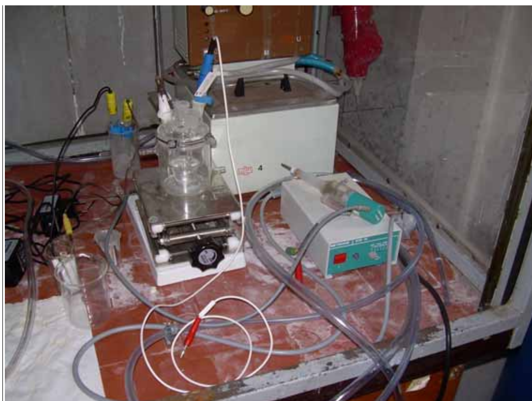
Obr. 8.3: Měřicí soustava tří elektrod s rotační pracovní elektrodou (položenou vpravo) pro voltametrická měření
