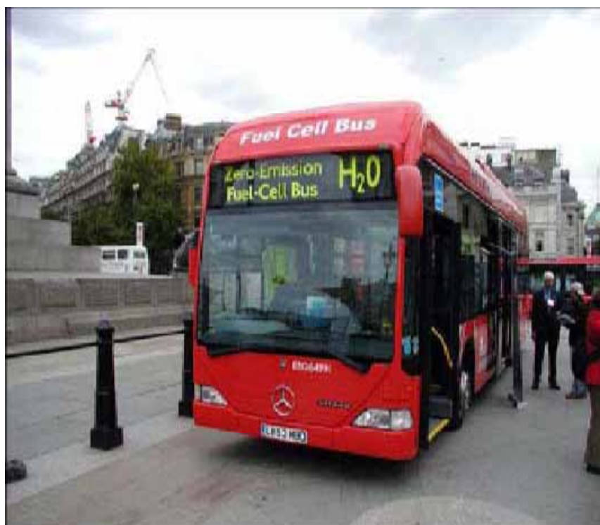
Obr. 2.9:Autobus s nízkoteplotními H 2 – O 2 články [5]
