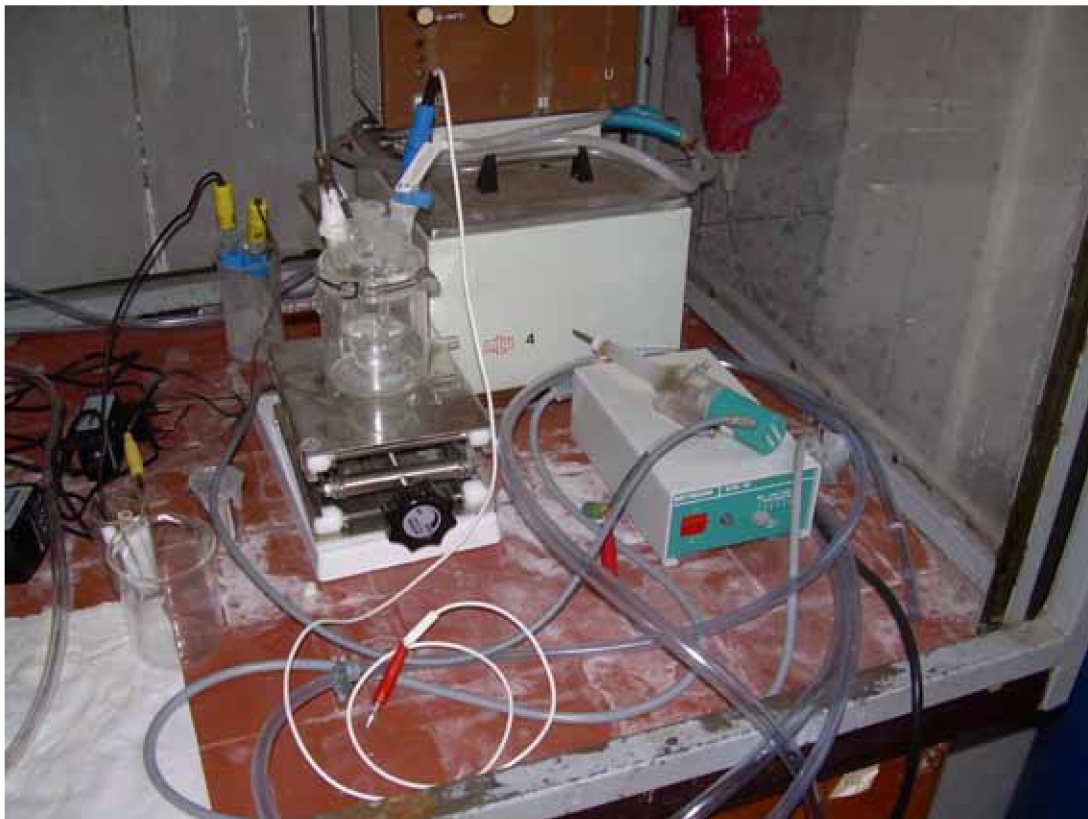
Obr. 6.4: Fotografie měřicí soustavy elektrod s odpojenou rotační pracovní elektrodou používanou během našich měření na FEKT VUT
