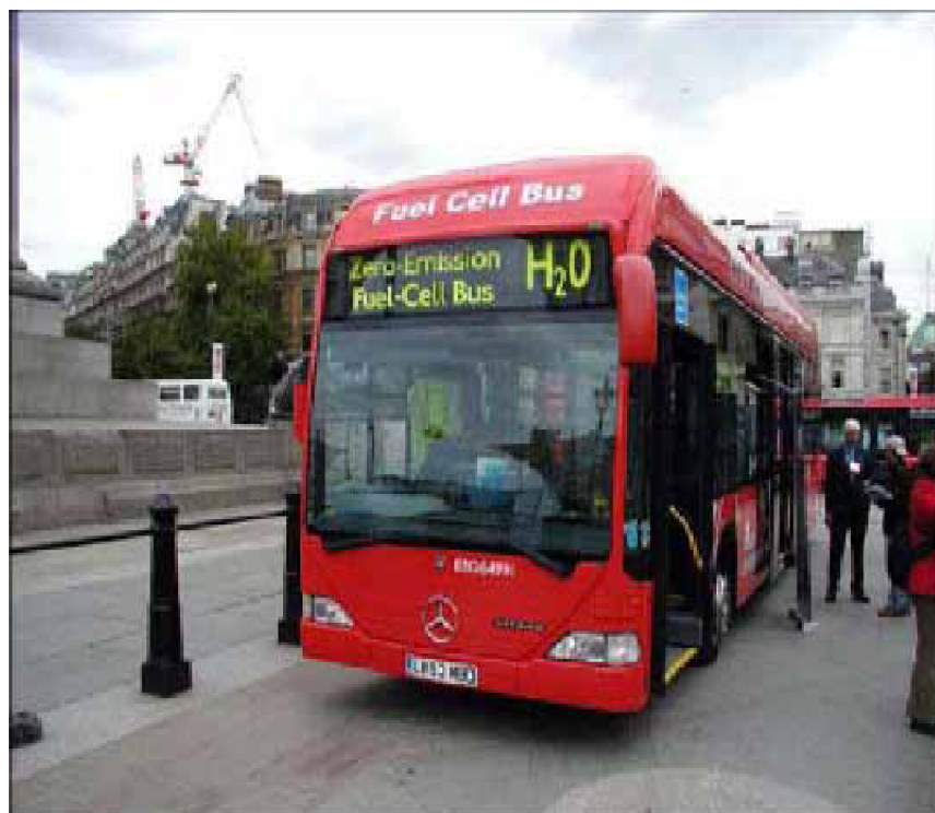
Obr. 2.9:Autobus s nízkoteplotními H 2 – O 2 články [5]
