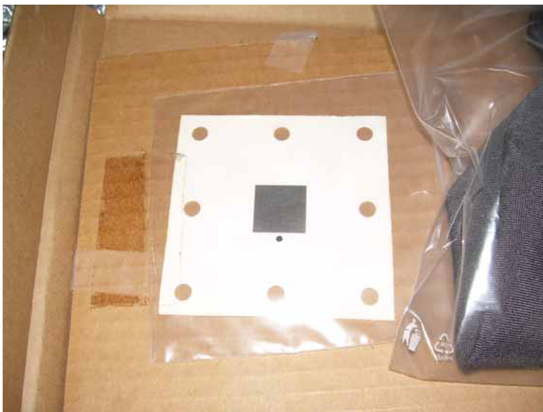
Obr. 10.1: Uhlíková elektroda s katalyzátorem na pozinkované síťce
