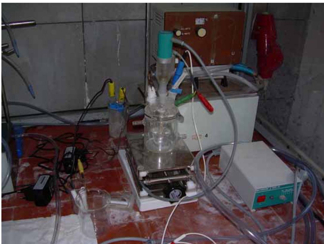
Obr. 6.5: Fotografie měřicí soustavy elektrod se zapojenou rotační pracovní elektrodou používanou během našich měření na FEKT VUT
