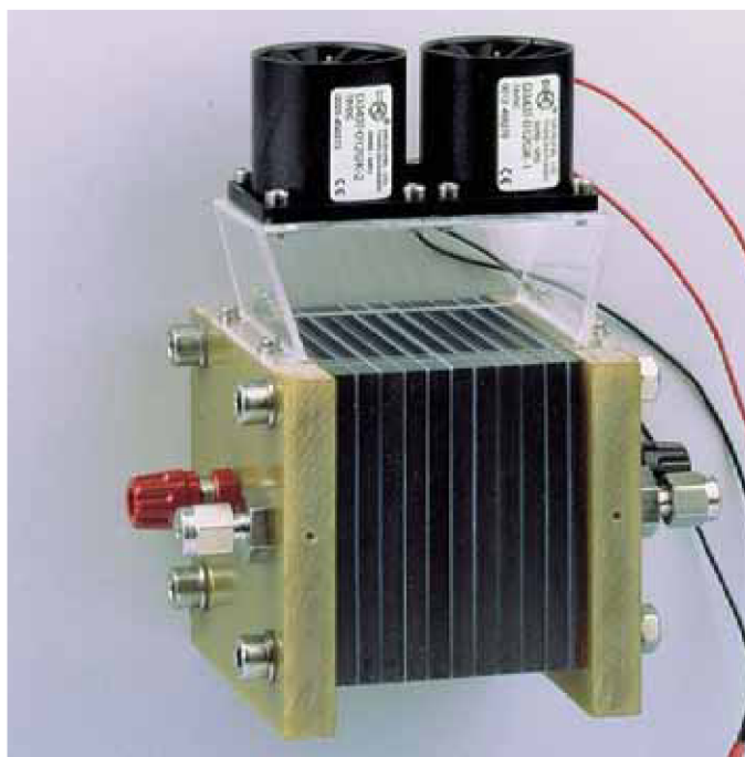
Obr. 2.4: Ukázka konstrukčního provedení experimentálního PEM článku [5]
