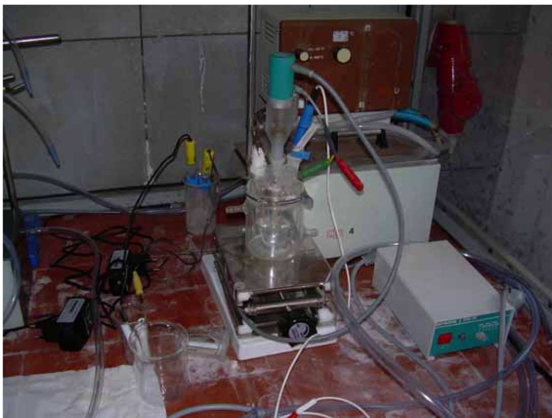
Obr. 8.4: Měřicí soustava tří elektrod s rotační pracovní elektrodou (uprostřed) pro voltametrická měření
