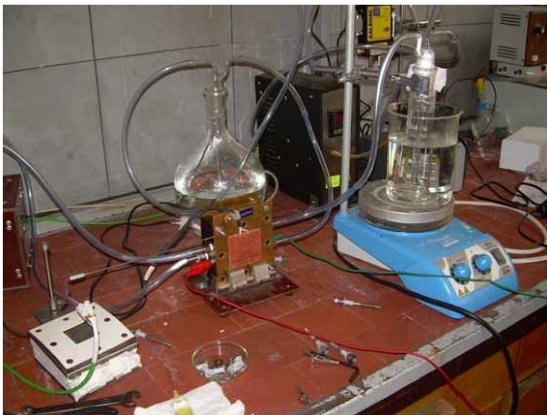
Obr. 8.2: Experimentální palivový článek včetně zařízení pro zvlhčování vodíku (vpravo) v laboratoři FEKT na Údolní
