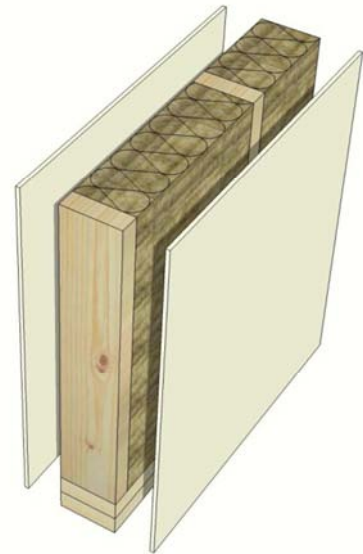
Obrázek 6 - Skladba příčky tl. 125mm (zdroj: vlastní tvorba)
