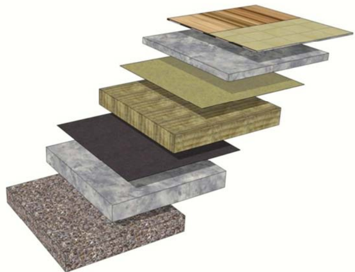
Obrázek 7 - Skladba podlahy na terénu s betonovou vrstvou tl. 60mm (zdroj: vlastní tvorba)
