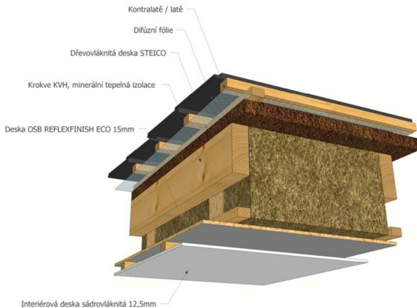
Obrázek 13 - Skladba nově navržené konstrukce střechy výběr pro „RD Haratice“ (zdroj: vlastní tvorba)
