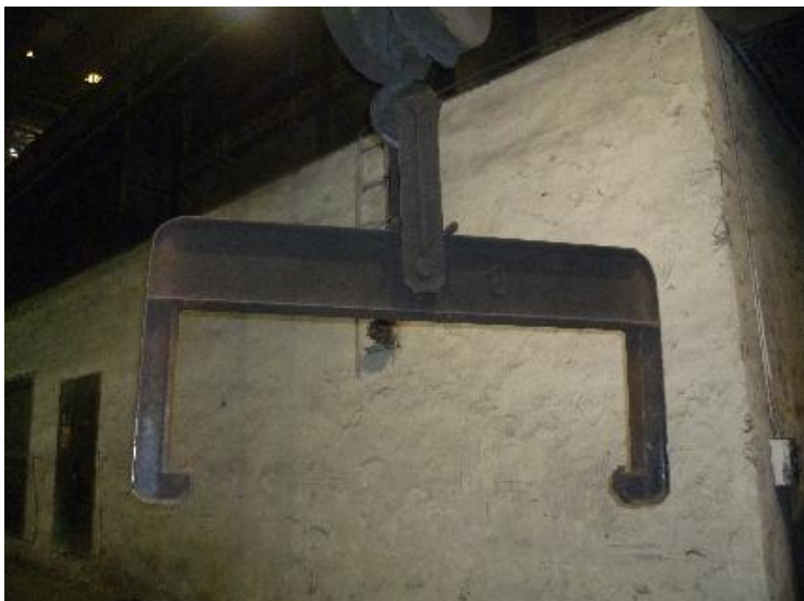
Obr. 9. - Závěs na šaržovací koše
