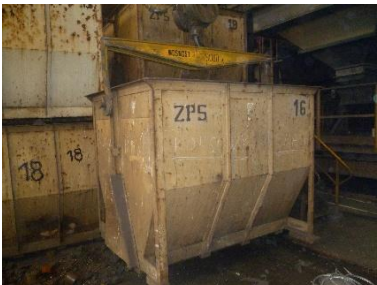
Obr. 11. - Zavěšený kontejner pomocí traverzy
