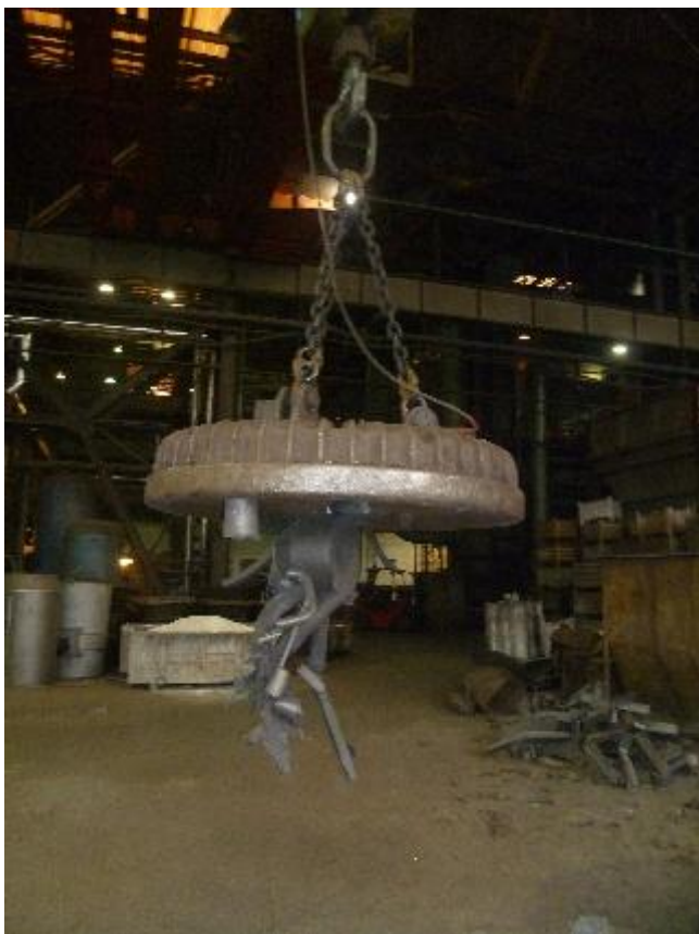
Obr. 12. - Hrozen materiálu na břemenovém elektromagnetu
