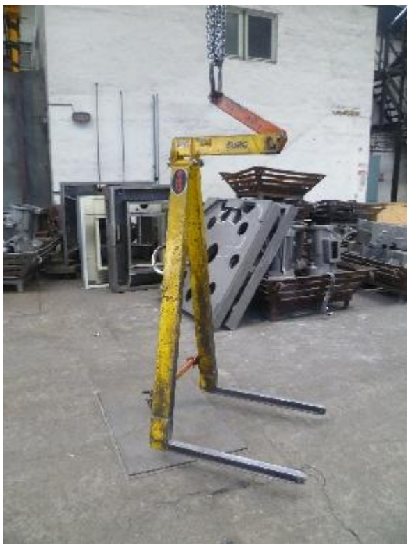
Obr. 7. - Samovyvažovací Euro závěs
