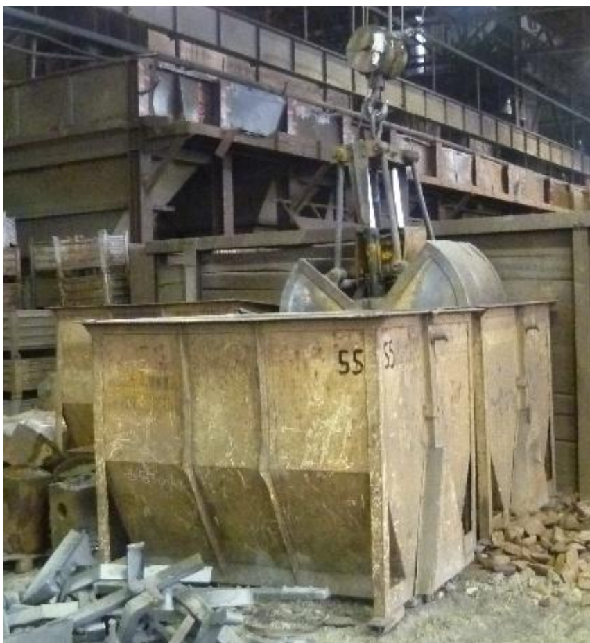
Obr. 13. - Nabírání materiálu lžicovým drapákem
