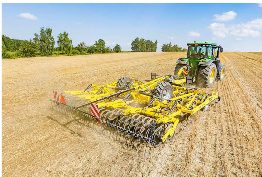
Obr. 4 Univerzální kypřič BEDNAR VERSATILL VO_PROFI [8]
