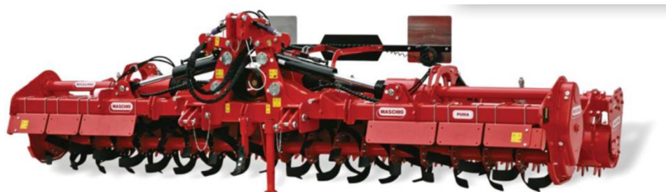
Obr. 2 Rotační kypřič Huschi-Puma [3]
