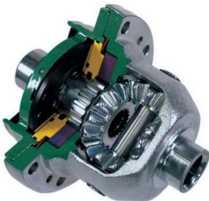
Obr. 3.16 Řez diferenciálem se spojkou Visco-Lok [34]
