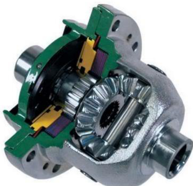
Obr. 3.16 Řez diferenciálem se spojkou Visco-Lok [34]
