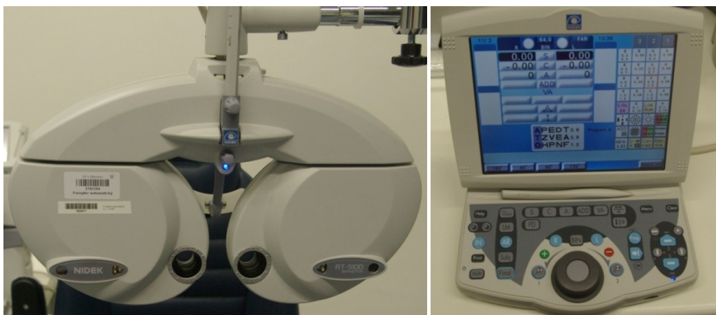
Obrázek č. 9 – Automatický foropter RT-5100 značky NIDEK použitý ve studii (vlevo hlava foropteru, vpravo ovládací skříňka)
