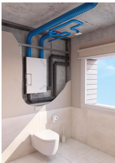
Obr. 14 Umístění VZT jednotky Avent G [19]
