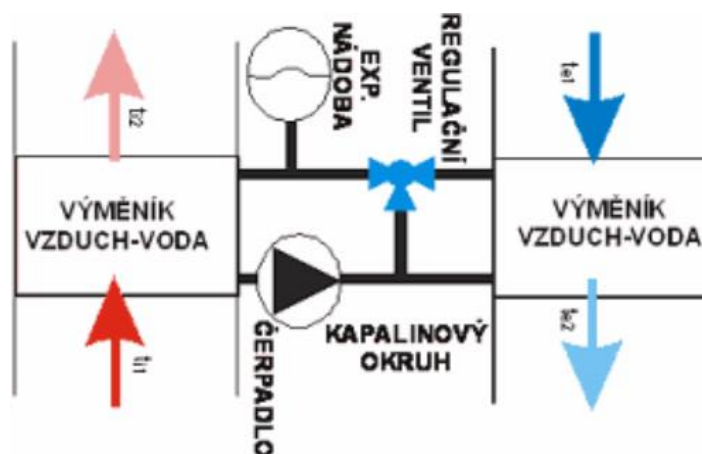
Obr. 3 Schéma kapalinového okruhu ve VZT jednotce [6]
