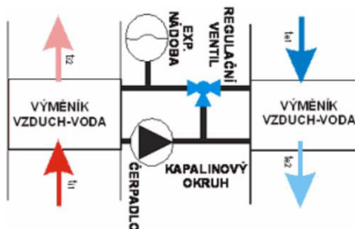
Obr. 3 Schéma kapalinového okruhu ve VZT jednotce [6]
