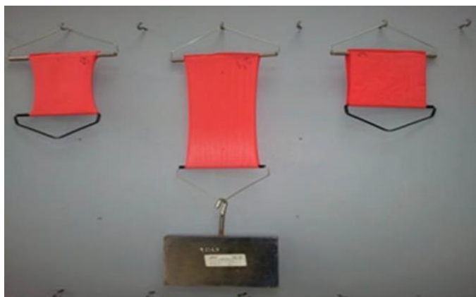
Obrázek 5: Zařízení pro napínání textilie [8]
