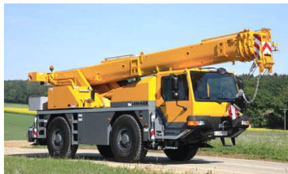
Obr. 5.6. Autojeřáb Liebherr LTM 1035 [23].
