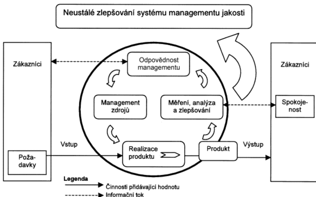
Obr. 2: Procesný model podľa ISO 9001 (2)
