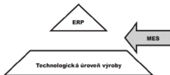
Obr. 9: MES systém v štruktúre informačného systému (11, s. 252)
