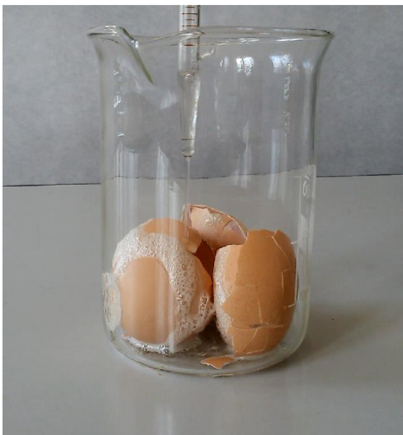
Obrázek 31- Průběh reakce po kápnutí HCl na vaječnou skořápku
