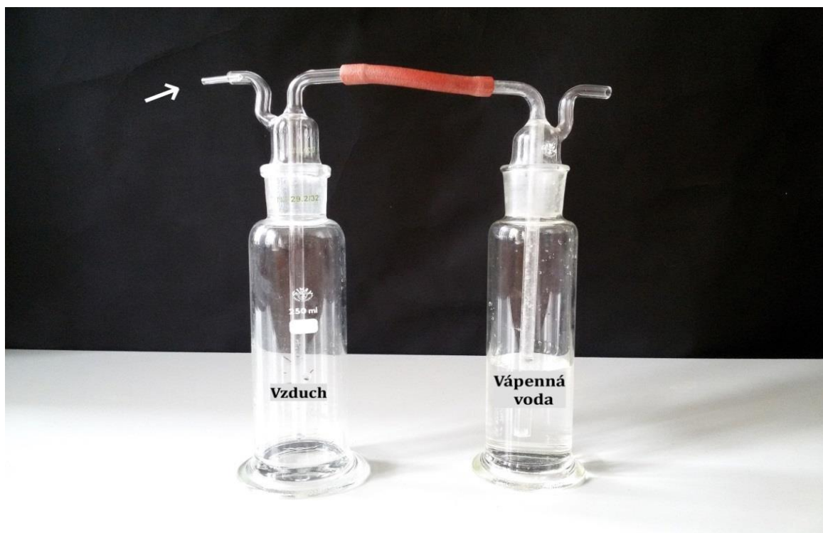
Obrázek 33- Aparatura s promývačkami
