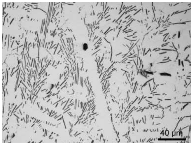
Obr. 22 Fáze Al_4C_3 v Pyroferalu [23]
