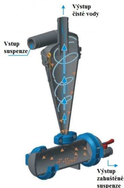
Obr. 28 Hydrocyklón pro odloučení pískových částic z odpadních vod [30]
