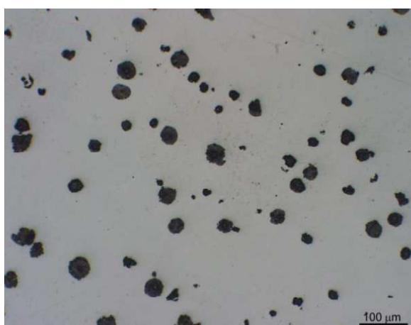
Obr. 31 Struktura austenitické niklové litiny bez karbidotvorných prvků [5]
