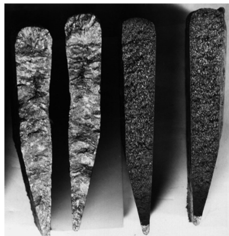
Obr. 4 Příklady zlomených zkušebních vzorků (vlevo: kompletní zákalka, vpravo: téměř kompletní šedé ztuhnutí) [13]
