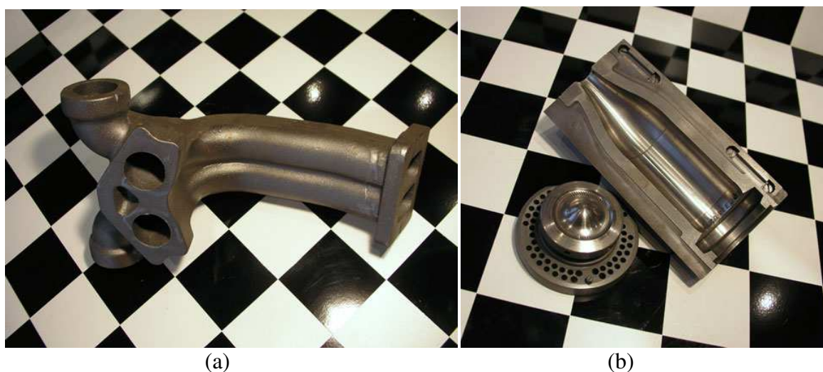
Obr. 18 Odlitky vyrobené ze slitiny SiMo (a) potrubí výfukové-střední (b) sklářská forma [21]
