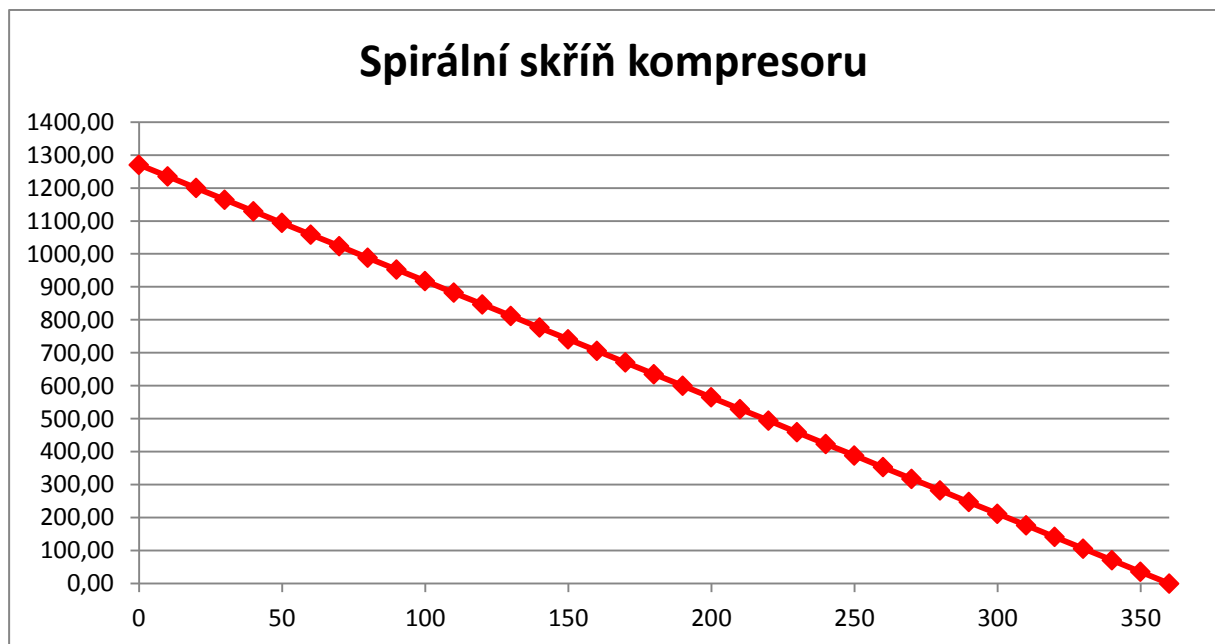
Obr. 26 Graf lineárního snižování plochy průřezu spirální skříně turbíny
