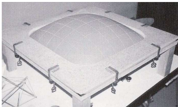
Obr. 2-3 Modelové získání tvaru pomocí gumové membrány[6]
