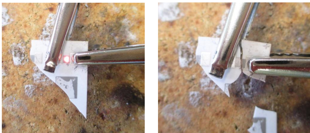
Obr. 5.2: Tepelné záření a prasknutí podložky vlivem vysoké teploty
