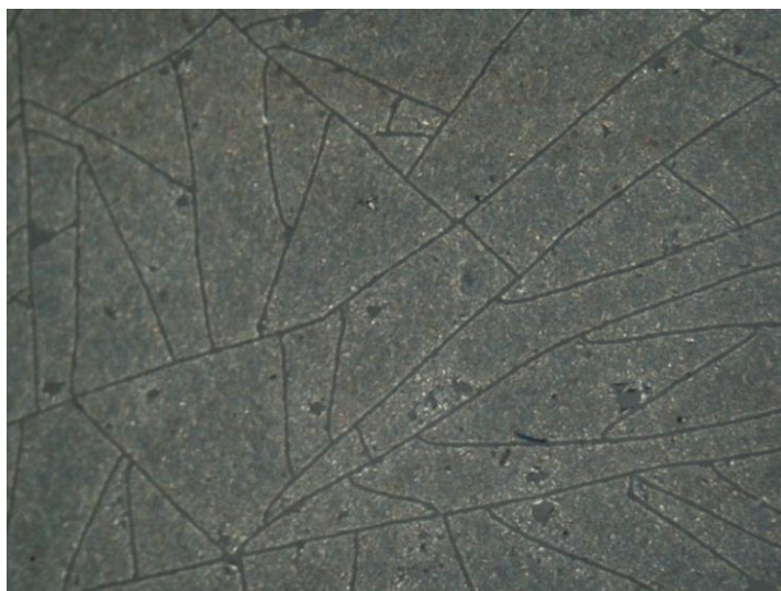
Obr. 3.22: Rozpraskaný povrch – snímek z optického mikroskopu
