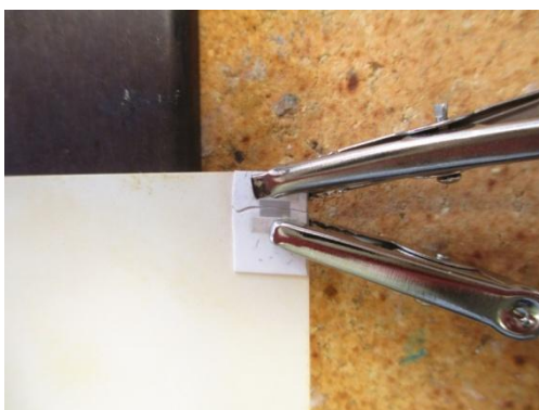
Obr. 5.3: Měření proudové nosnosti na segmentu č. 7
