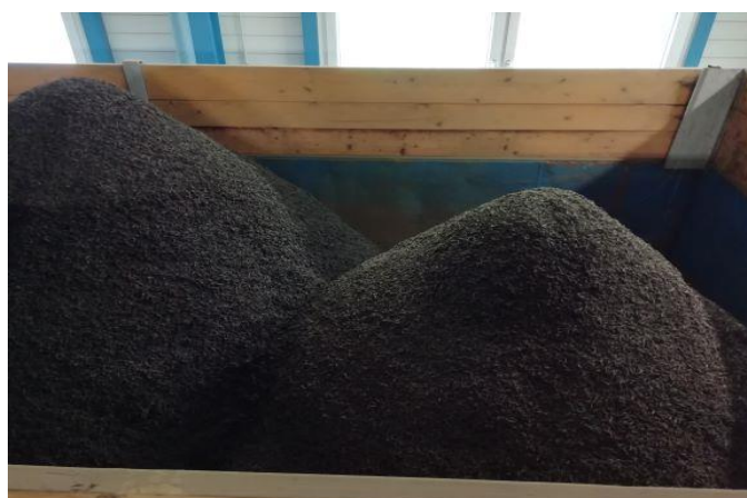
Obr. č. 19 – Výsledný vysušený kal ČOV -Drahovice (foto autor, 2019)
