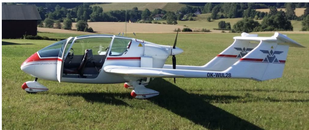
Obr. 1 – Řešení dveří u letounu Sparrow ML [15]
