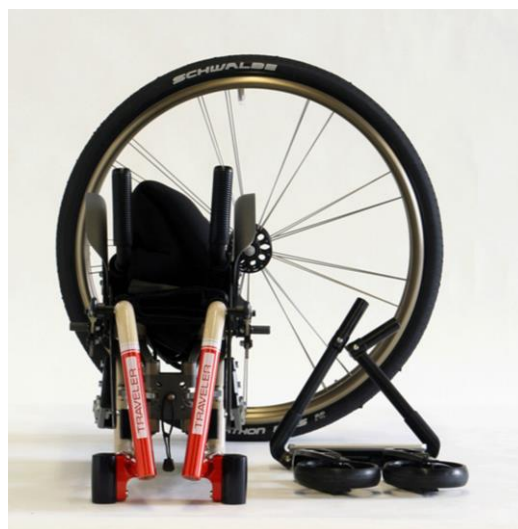
Obr. 11 – Složený aktivní invalidní vozík Pro Activ Traveler [32]
