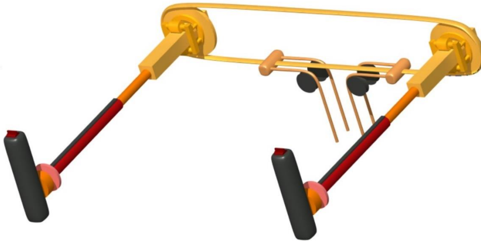
Obr. 32 – Schéma soustavy s dvojitým řízením směrového kormidla a příďového kola
