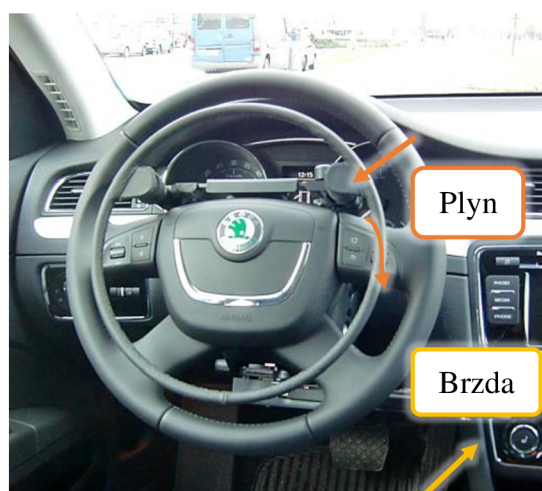
Obr. 19 – Ovládní plynu kroužkem a brzdy pákou [43]
