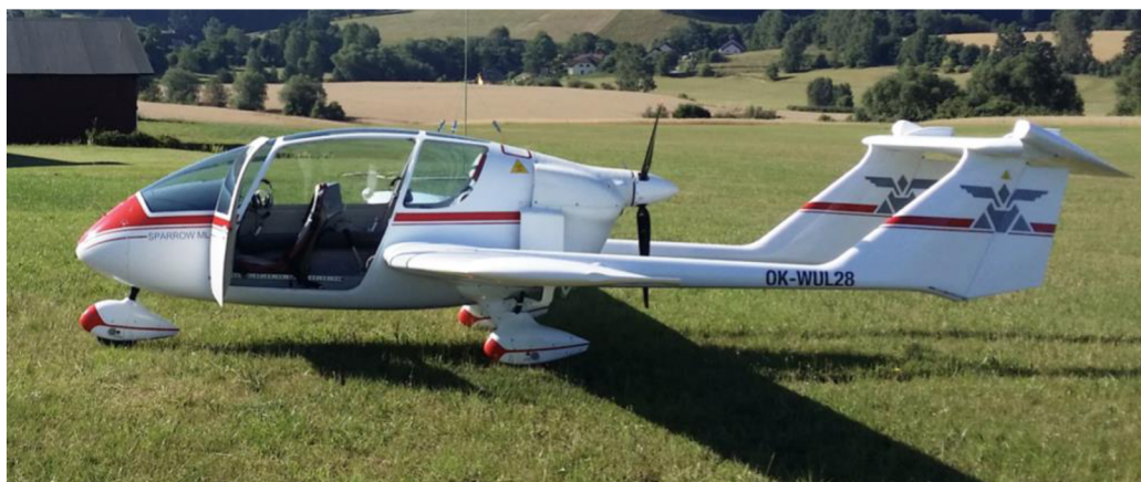
Obr. 1 – Řešení dveří u letounu Sparrow ML [15]
