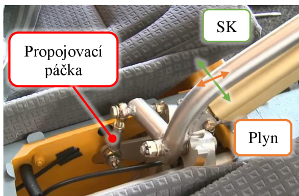
Obr. 21 – Propojovací páčka k rozšíření funkce plynové páky [45]
