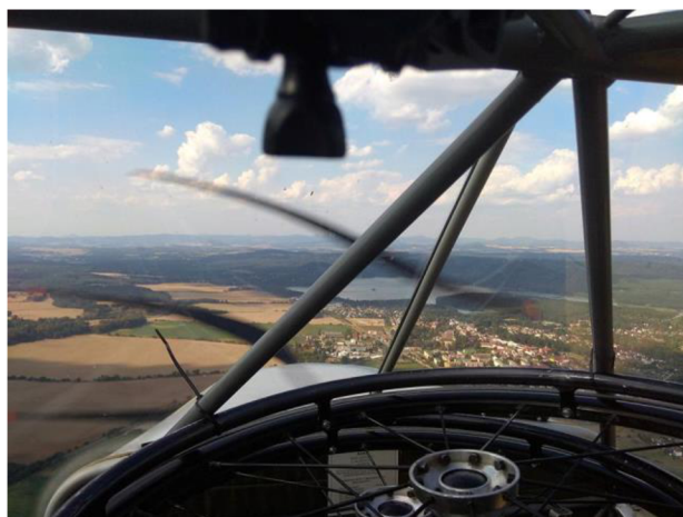
Obr. 2 – Nevhodné uložení invalidního vozíku na palubní desce letounu [16]
