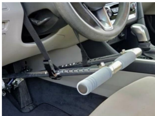
Obr. 17 – Přenosné ruční řízení [41]
