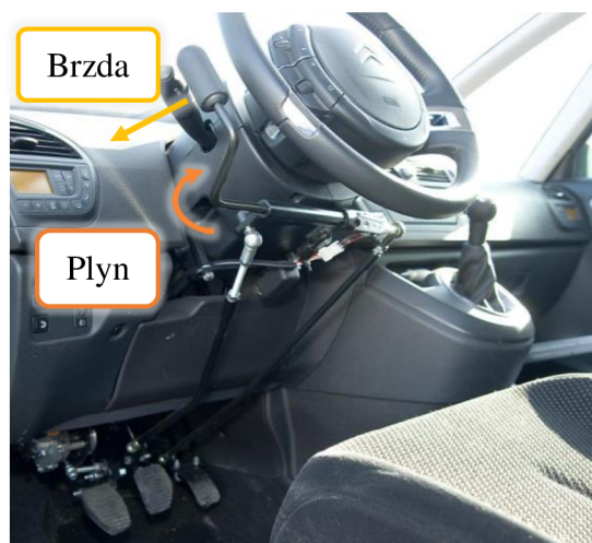
Obr. 18 – Ovládní plynu a brzdy pomocí páky [42]
