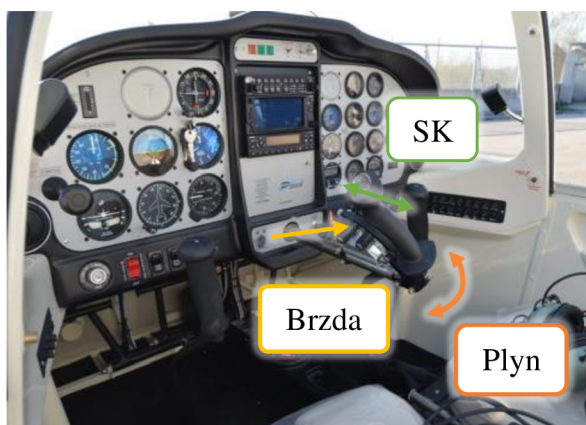
Obr. 24 – Ruční řízení Tecnamu P2002JF [47]
