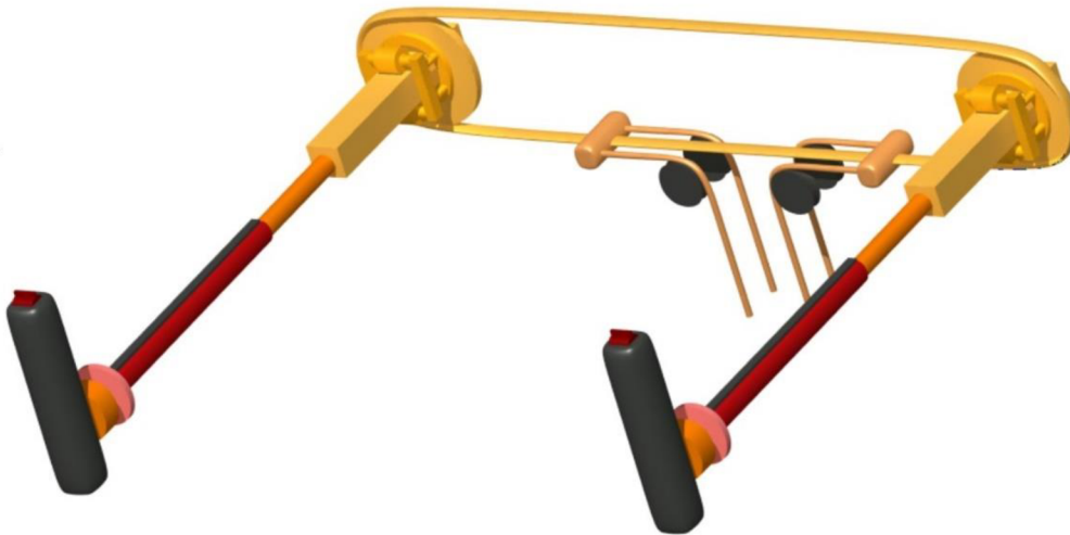
Obr. 32 – Schéma soustavy s dvojitým řízením směrového kormidla a předového kola
