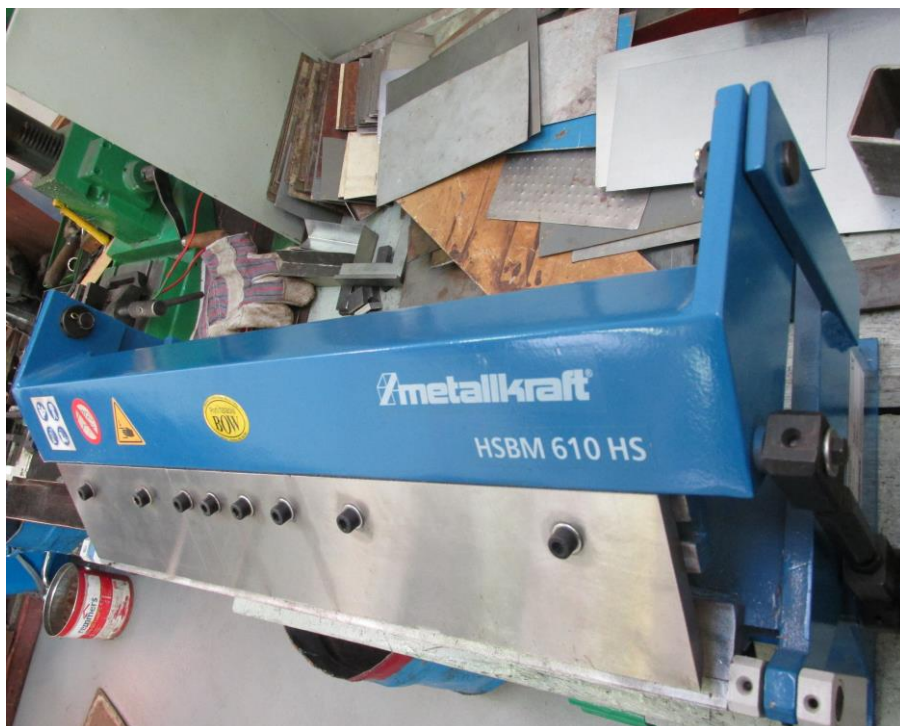
Obrázek 11: Uložení přítlačné lišty složené ze segmentů na pantu
