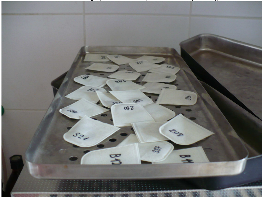
Obr. č. 3. Filtrační sáčky (Ankom F57) určené do přístroje Ankom 220 Fiber Analyzer.
