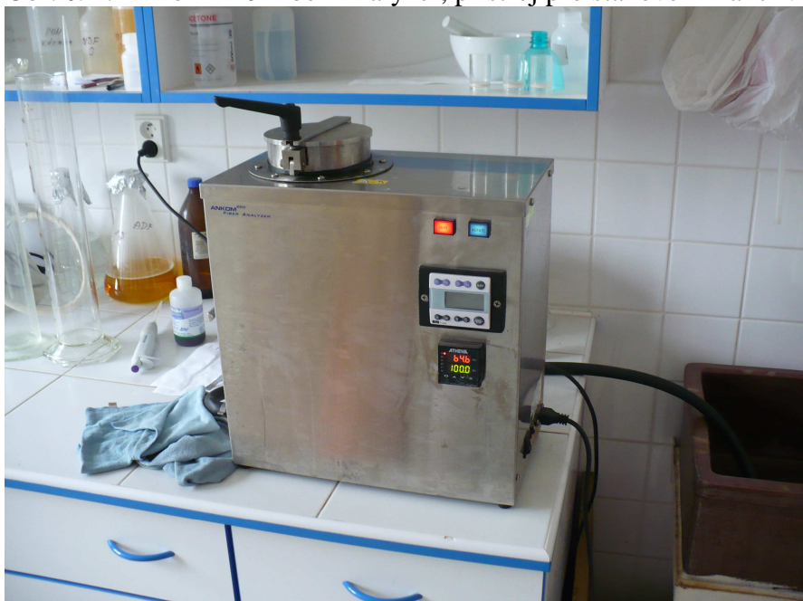
Obr. č. 4. Ankom 220 Fiber Analyzer, přístroj pro stanovení frakcí vlákniny.
