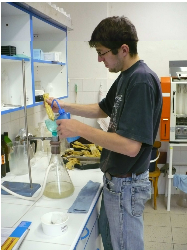
Obr. 2. Filtrace nezdegradovaných reziduí vzorků z nylonových sáčků do filtračních sáčků Ankom F57.
