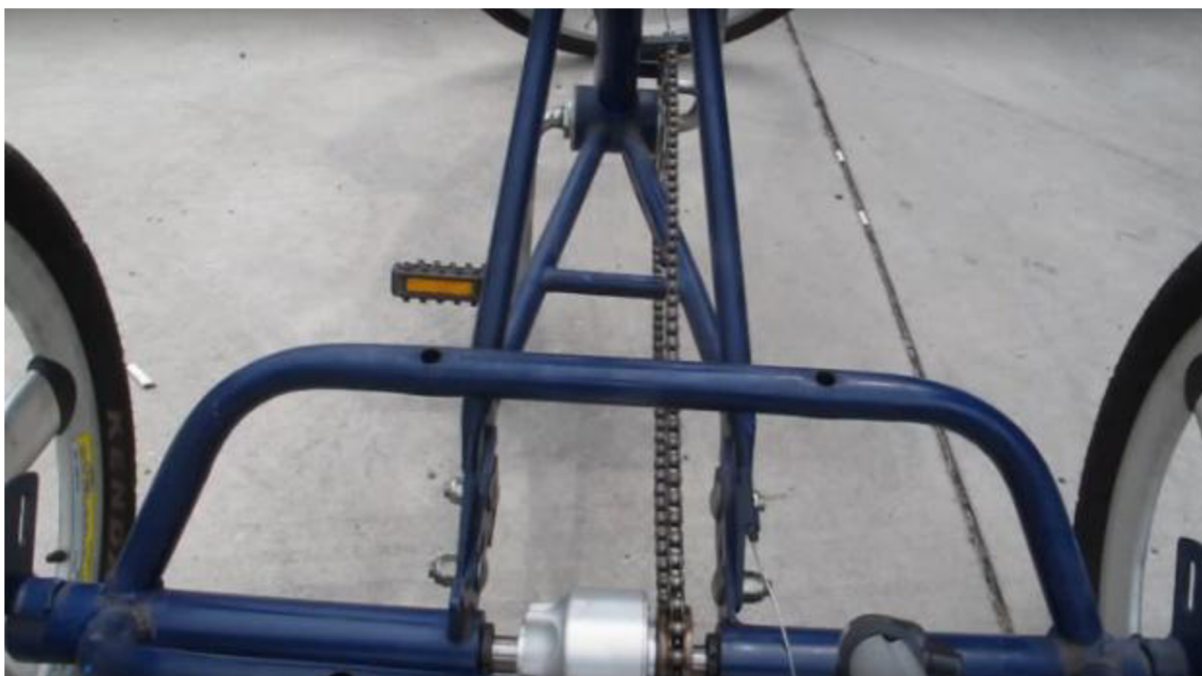
Obr. 5.4 Přenos momentu z pedálu přímo na diferenciál [16]
