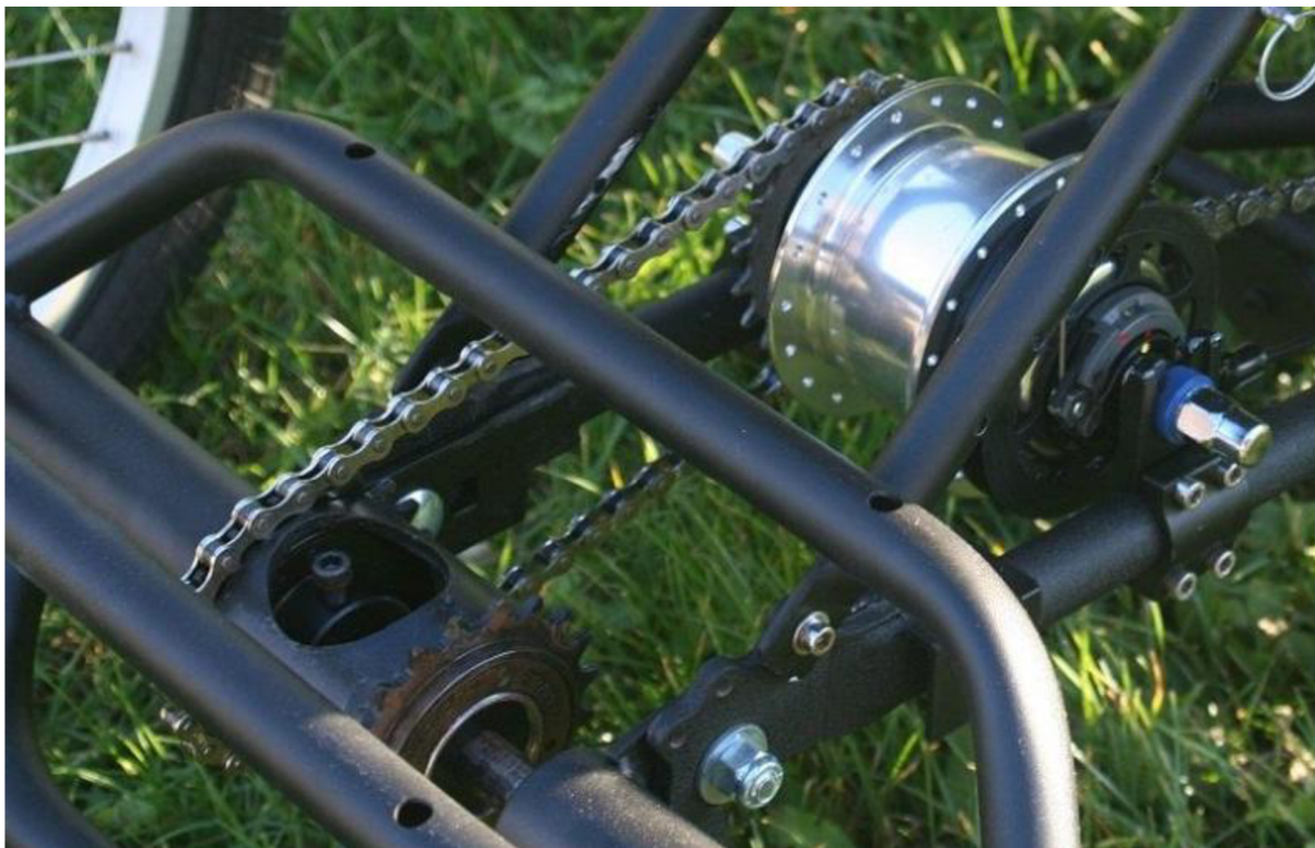
Obr. 5.4 Rozdělení hnacího momentu pomocí volnoběžek [35]
