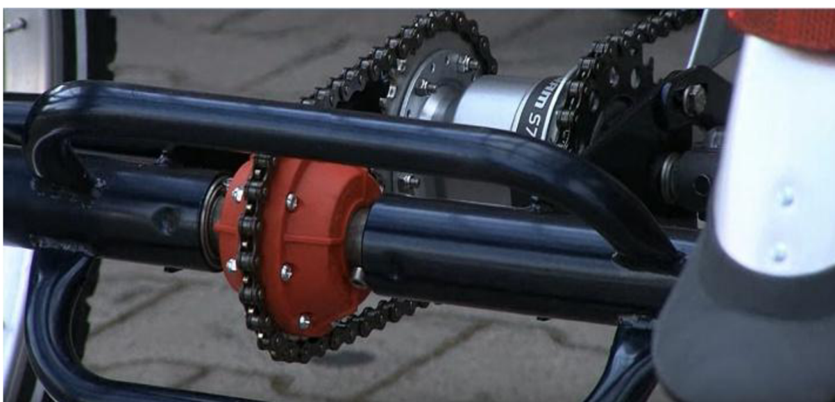
Obr. 5.6 Přenos momentu přes vložený vícerychlostní náboj [36]
