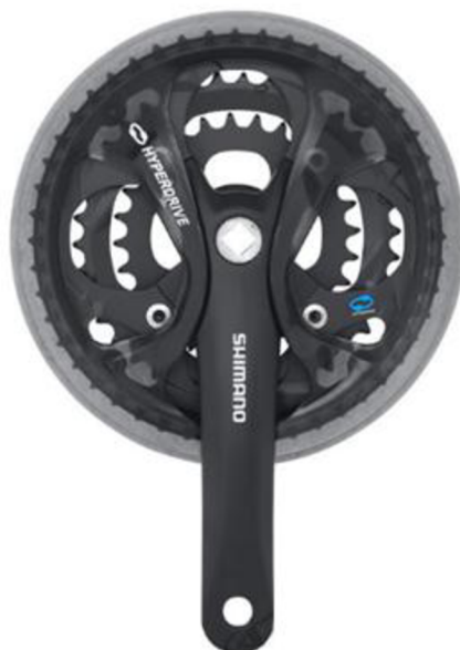
Obr. 7.2 Převodník s klikou Shimano FC – M361 [29]
