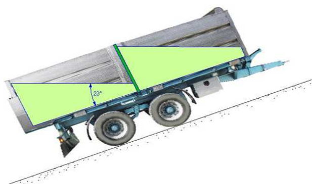
Obrázek 10: Funkce dělicích přepážek (RAINOX, 2015)
