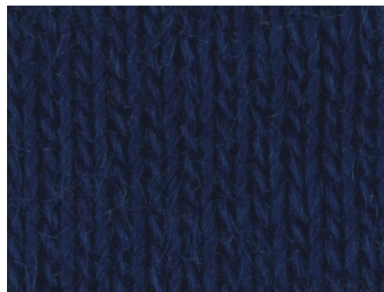
Obrázek 32 CO/PA 22 dtex po 20 000 otáčkách oděru
