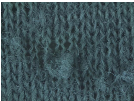
Obrázek 29 CO/PA 44 dtex po 20 000 otáčkách oděru
