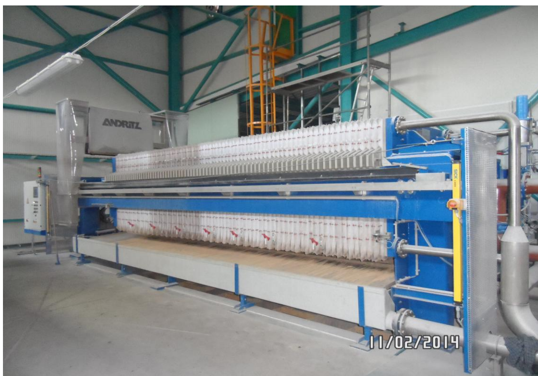
foto č. 34, Membráno komorový kalolis, typ MKFP 1500/80 (foto: vlastní, 02/2014)
