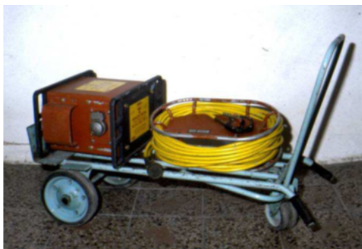
Obrázek 2.5: Gamagrafijský kryt TECH/OPS se zářičem CO60 na transportním vozíku s hadicemi ovládacího zařízení [23]
