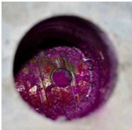
Obrázek 2.14: Návrh k ocelové chrániče Sandrik v předpjatém nosníku, následné vylomení vývrtu, dovtáčení k výztuži a realizace fenolftaleinové zkoušky [16]
