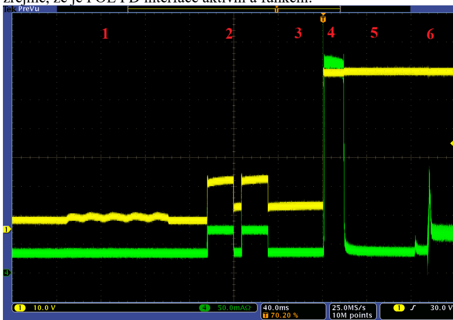
Obr. 5-13 Komunikační sekvence s POE PSE MaxLink, napětí na vstupu (žlutý průběh), vstupní proud (zelený průběh)
