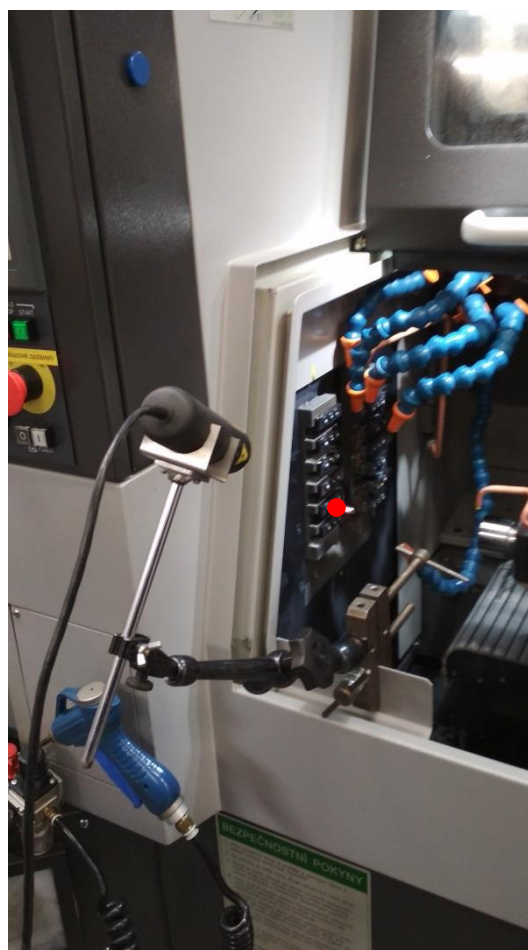
Obr. 26) Umístění snímače otáček u prvního měření
