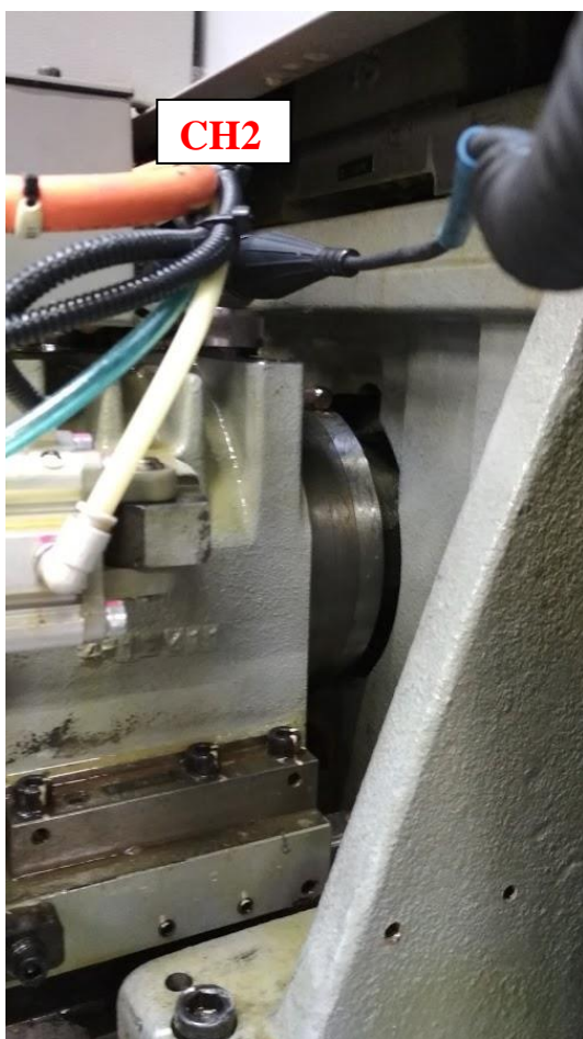
Obr. 32) Umístění snímače na hlavním vřetenu u druhého měření
