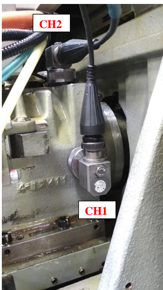
Obr. 25) Umístění snímačů vibrací u prvního měření
