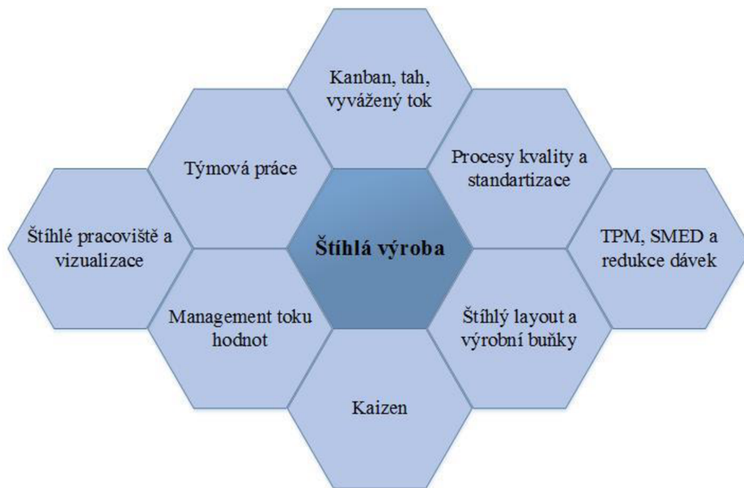
Obr. 2: Struktura štíhlé výroby (Zdroj: Košturiak, 2006)
