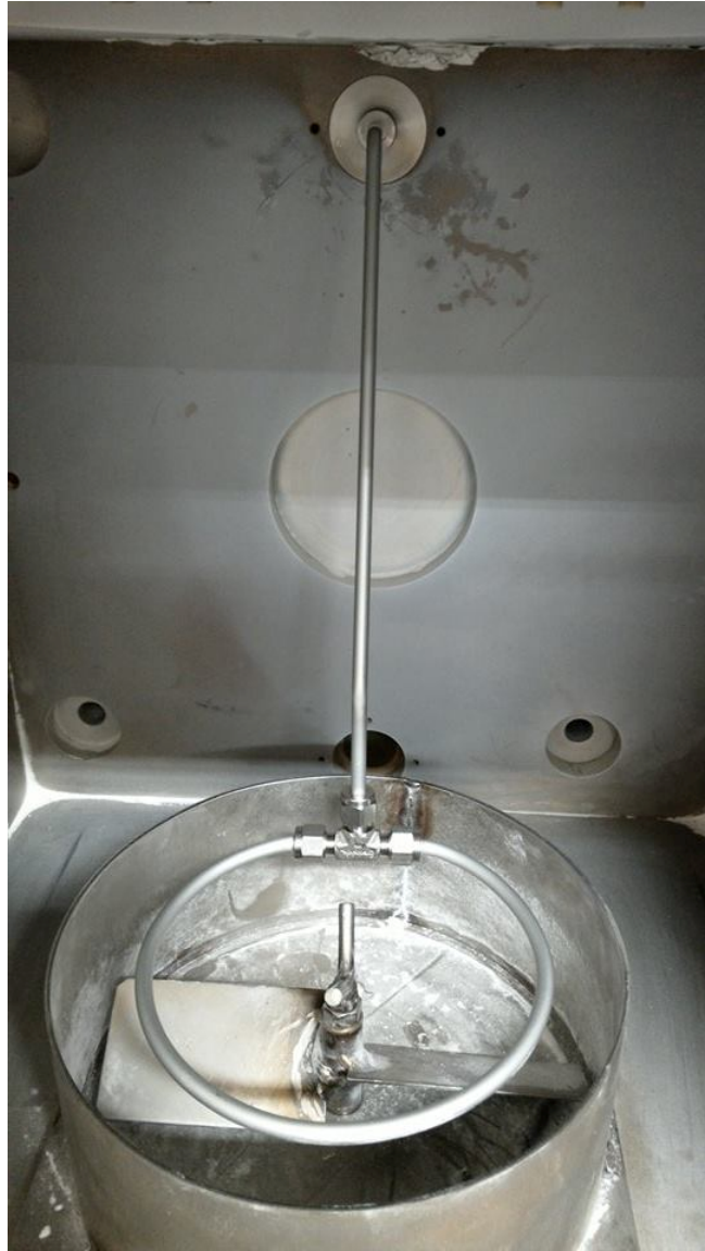
Obrázek 23: Zařízení „gas ring“ uvnitř recipientu
