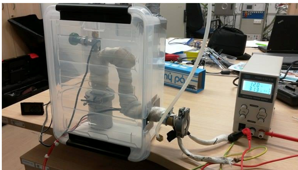
Obrázek 11: Výparník připojený ke stabilizovanému zdroji
