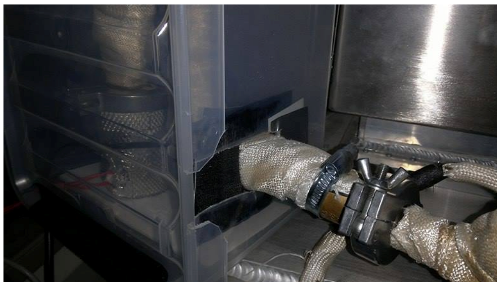
Obrázek 20: Uzpůsobení boxu pro snadné vyjímání výparníku
