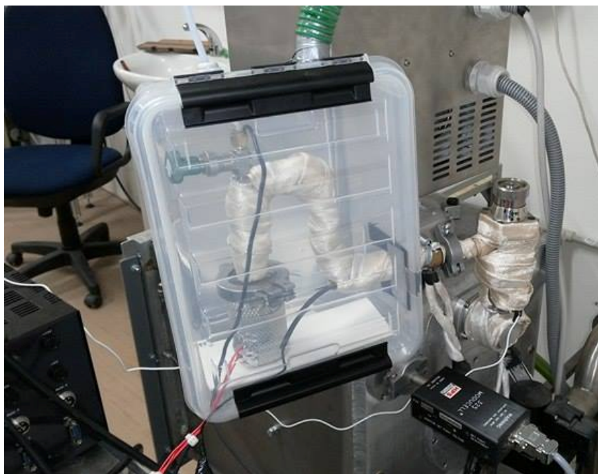
Obrázek 18: Konečná úprava výparníku s instalovanými topnými pásy
