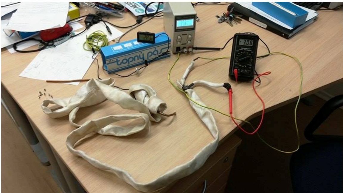
Obrázek 17: Testování rozsahu vyhřívacích teplot na zkušební trubičce
