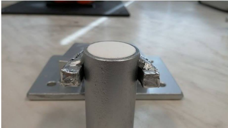
Obrázek 27: Objímka s vylisovanou tabletou uvnitř
