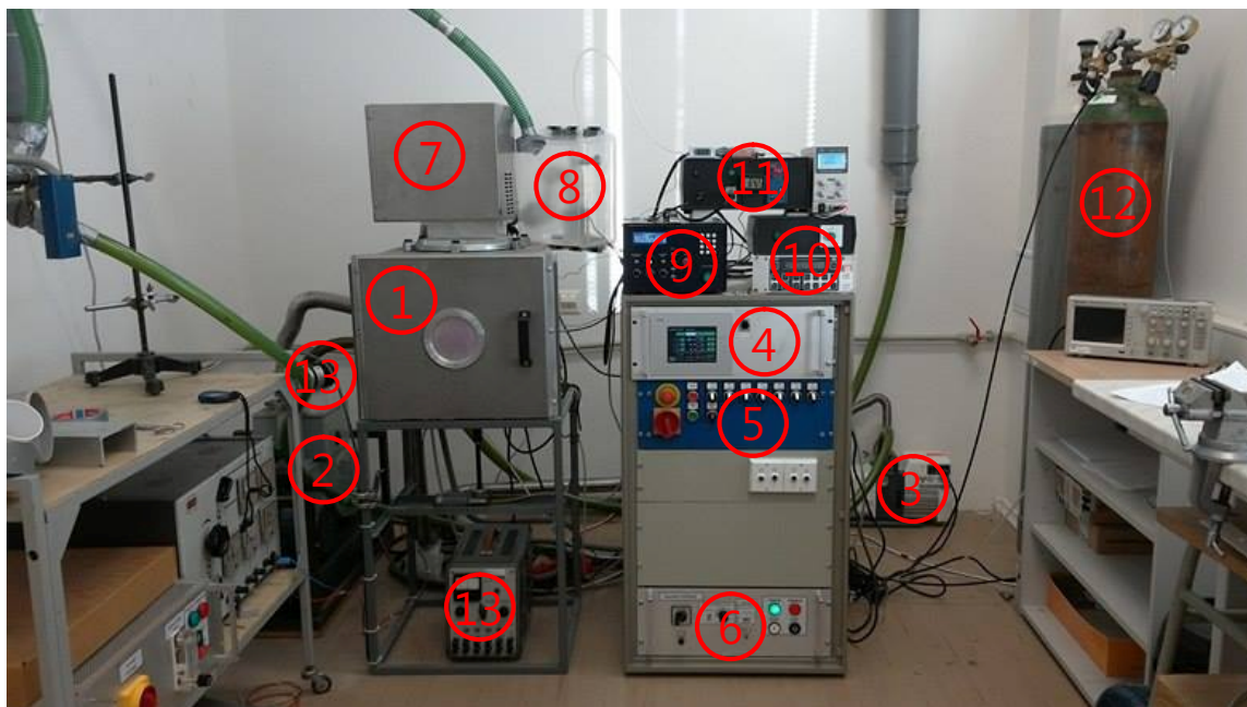
Obrázek 8: Přístroje a součásti nízkotlaké plazmové aparatury CX 22
