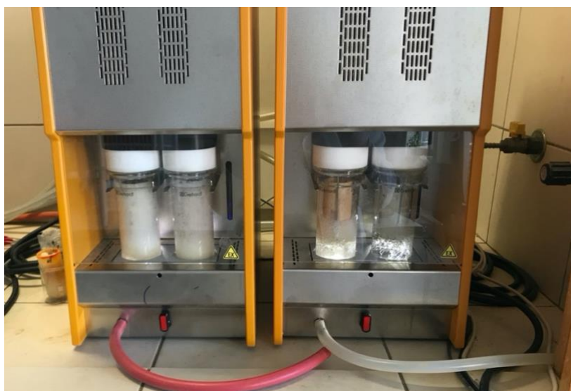
Obr. 13 Prebiehajúca extrakcia v hexane na prístroji Soxtherm
