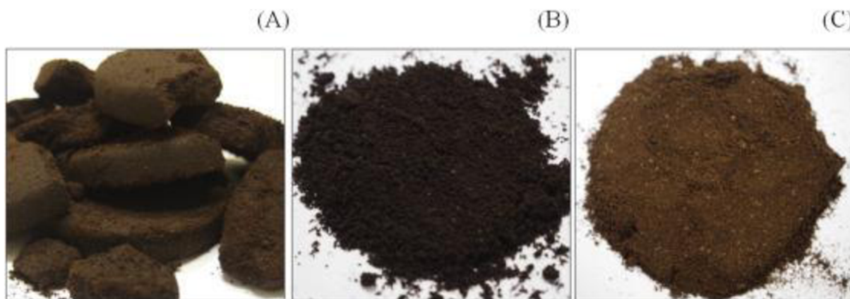
Obr. 6 Káva pred a po procese extrakcie. A) čerstvé kávové usadeniny po prípravení kávového nápoja, (B) usušené kávové usadeniny, (C) kávové usadeniny zbavené tukov, po extrakcii oleja [31]
