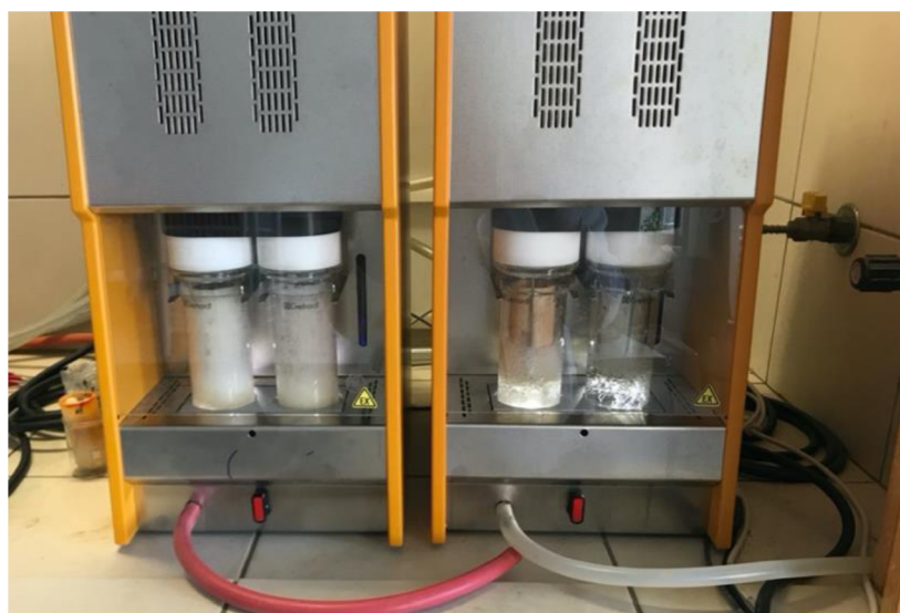
Obr. 13 Prebiehajúca extrakcia v hexane na prístroji Soxtherm
