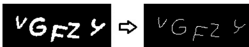
Obrázek 5.9: Nalezení kostry objektů pomocí ztenčení čar metodou Thin Lines
