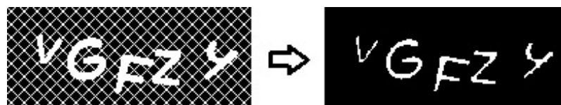
Obrázek 5.6: Odebrání okrajových pixelů objektů metodou Erode
