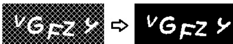
Obrázek 5.8: Odstranění statického pozadí jeho odečtením se zachováním celistvosti popředí
