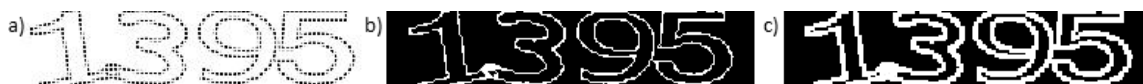
Obrázek 6.5: Schéma Stitch s "rozdrobením" na obdélníčky; a) originální schéma; b) po zpracování metodou Fill 1px Gaps; c) zpracování metodou Dilate
