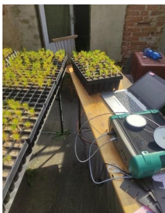
Obrázek 10: Pracovní plocha se spektrometrem FieldSpec® 3. Na něm se nachází bílá reference.
