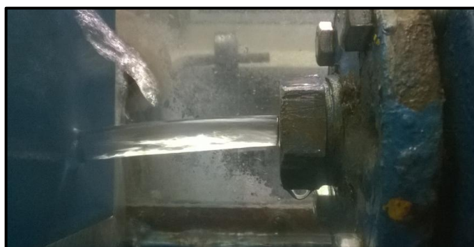
Obr. 3.1.3 Vliv tíhového zrychlení na tvar paprsku
