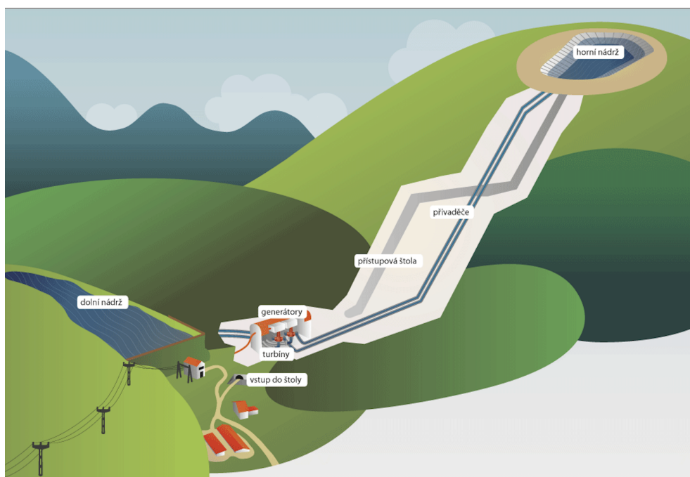
Obr. 4.6: Schéma přečerpávací elektrárny [18]
