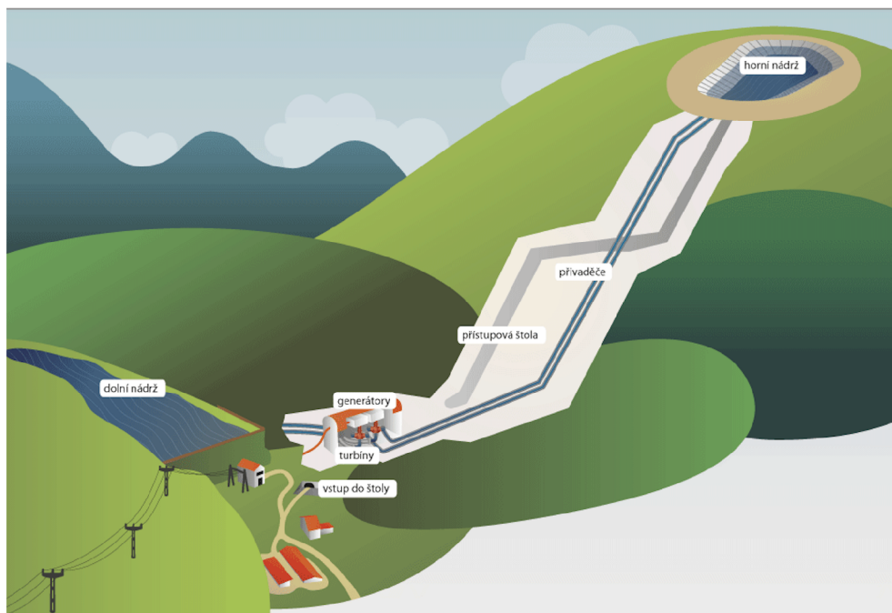
Obr. 4.6: Schéma přečerpávací elektrárny [18]
