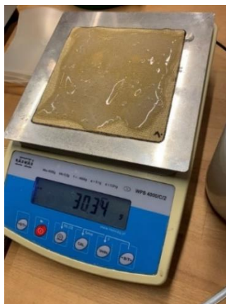
Obr. 21 Nanosená nanocelulóзовá suspenze s konopnou tkaninou a její vážení před sušením
