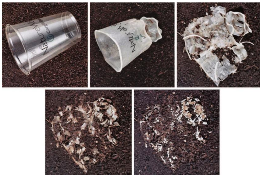
Obr. 8 Biologický rozklad PLA kalíšku po dobu 2 měsíců [30]
