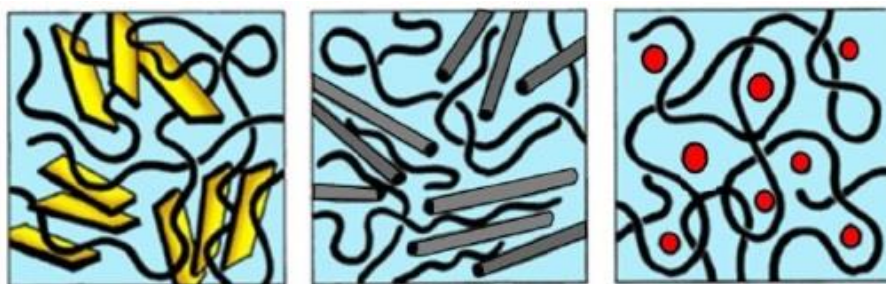
Obr. 3 Typy nanokompozitů s polymerní matricí a) vrstvené b) vláknové c) částicové [15]
