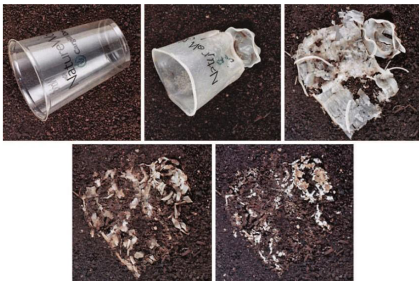
Obr. 8 Biologický rozklad PLA kalíšku po dobu 2 měsíců [30]
