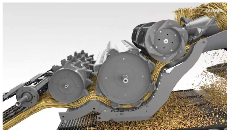
Obrázek 1.7: Dvoububnové mláticí ústrojí Claas APS (Claas.cz, 2024)
