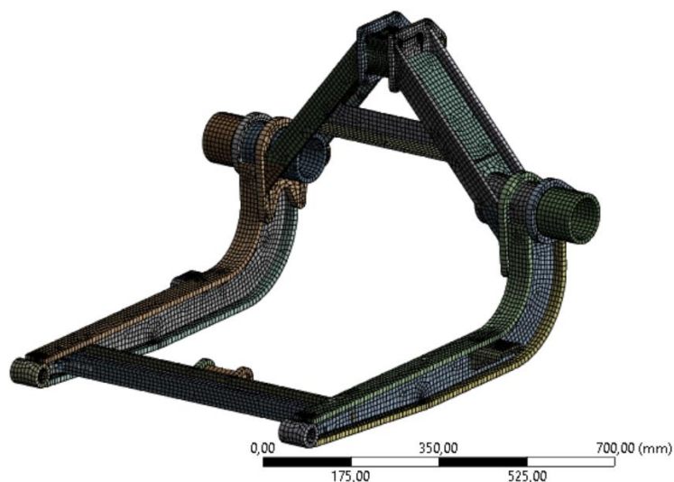
Obr. 56: Síť MKP modelu rámu (po konstrukčních úpravách)
