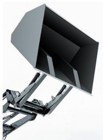
Obr. 8: Vysokovýklopná lopata čelního nakladače [14]
