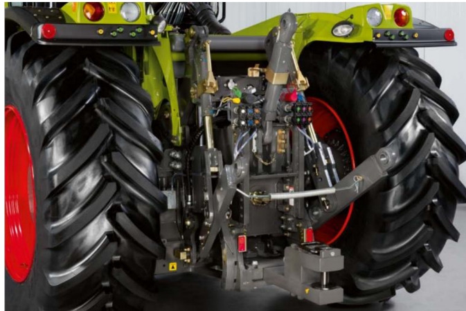
Obr. 5: Zadní tříbodový závěs traktoru CLAAS Xerion [16]
