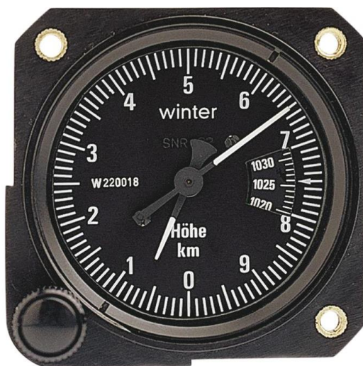
Obr. 2.4: Analógový mechanický výškomer 3 .
