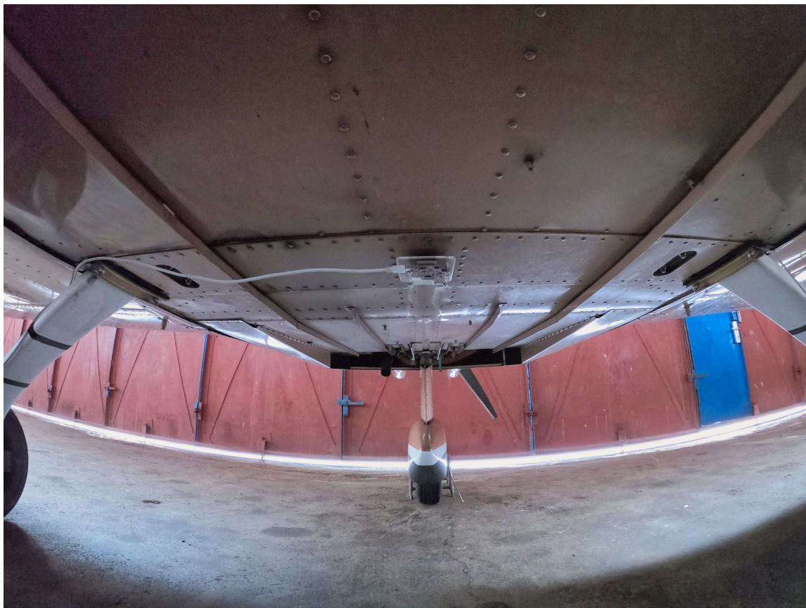
Obr. 5.4: Osadenie modulu na trupe lietadla - pohľad odzadu
