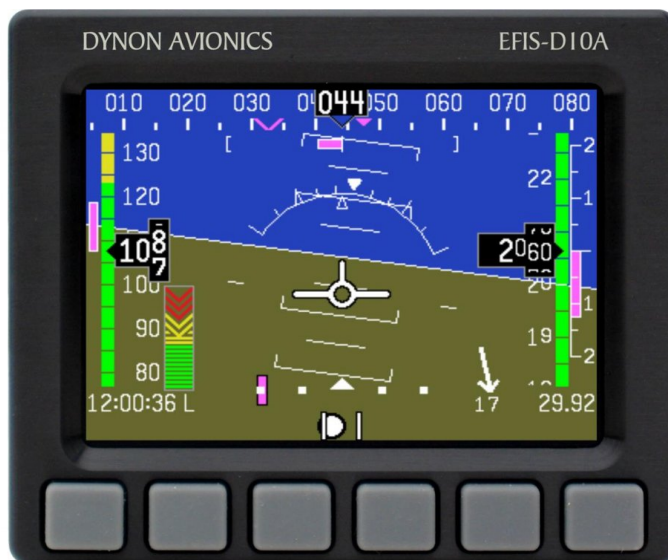
Obr. 2.5: Digitálny ukazateľ typu glass cockpit 4
