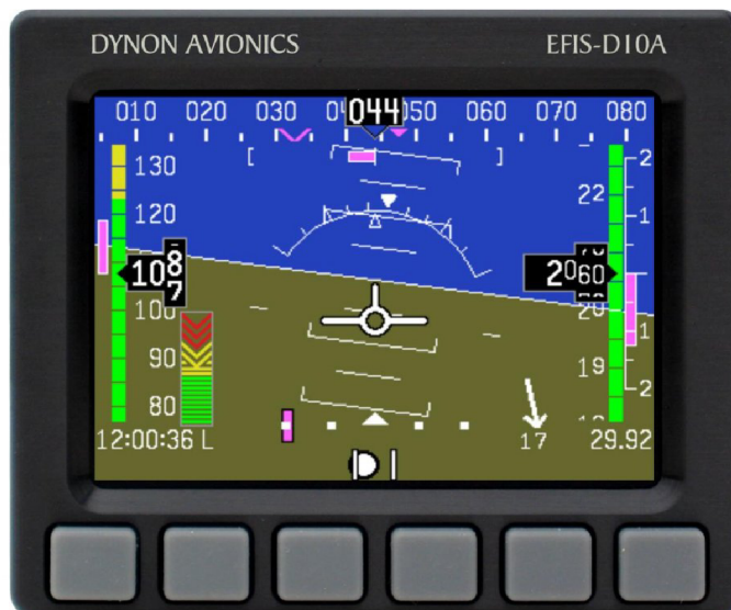
Obr. 2.5: Digitálny ukazateľ typu glass cockpit 4
