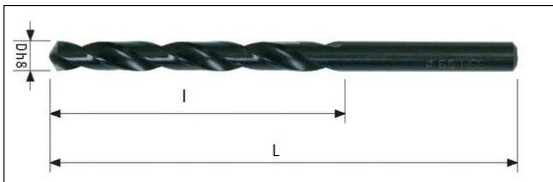
Obr. 24. Vrták z HSS ČSN 221121
