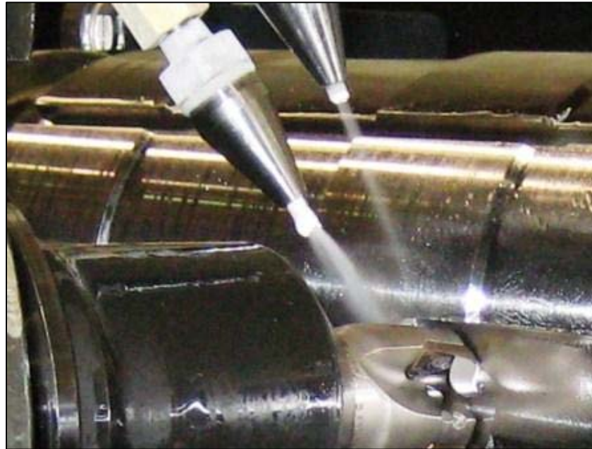
Obr. 7. Chlazení stlačeným CO 2
