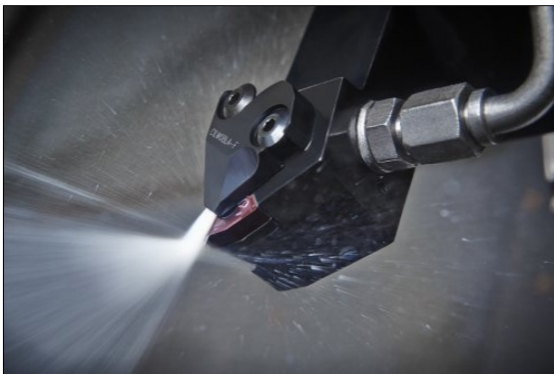
Obr. 5. Vysokotlaký přívod procesní kapaliny tělem nástroje
