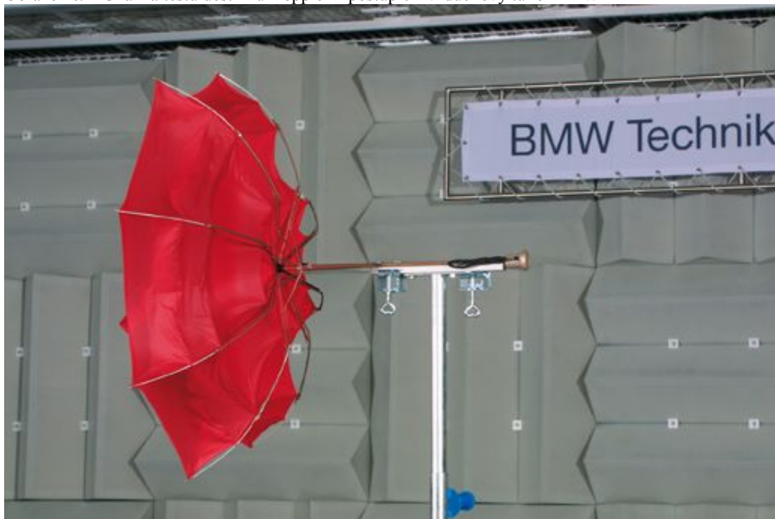
Obrázek č. 4 Ukázka testu deštníku Doppler – postup 02-vzduchový tunel BMW
