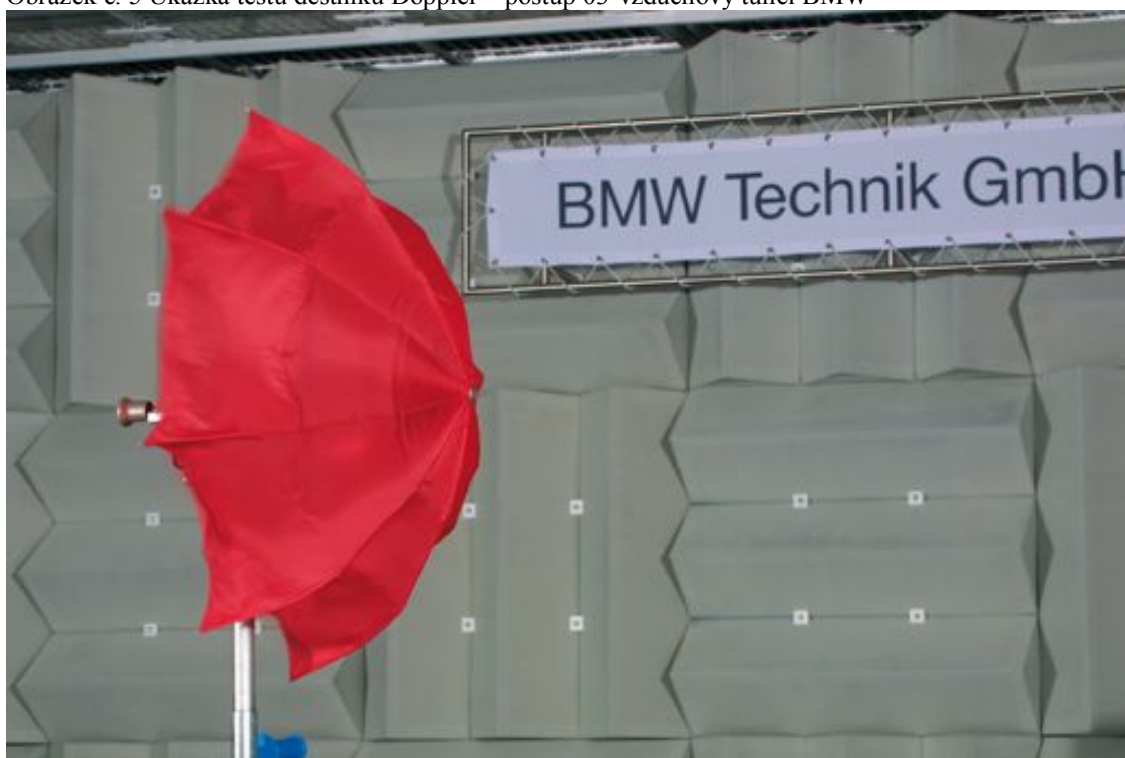
Obrázek č. 5 Ukázka testu deštníku Doppler – postup 03-vzduchový tunel BMW
